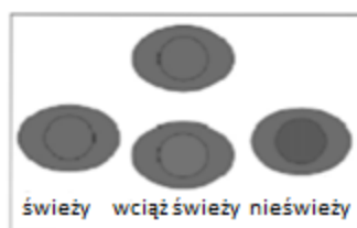
Rysunek 1. Zastosowanie wskaźnika świeżości z wykorzystaniem filmu z polianiliny (PANI) w opakowaniach inteligentnych [Kuswandii in., 2012]
